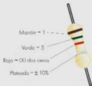
Figura 2. Resistencia de 1500 Ω al 10%
