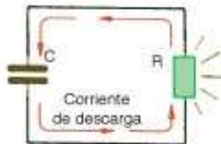
Fig. 7 La energía almacenada se disipa en calor
