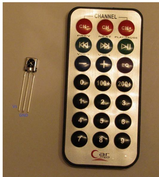
**Fig.3.31.** Sensor de infrarrojos y mando a distancia empleados en el Proyecto 11
