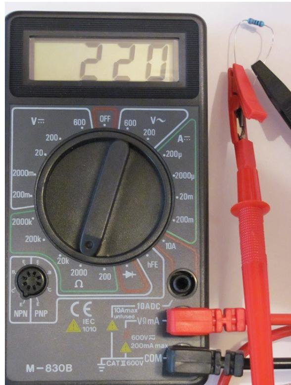
**Fig.2.4.** Valor de la resistencia medido con un multímetro
