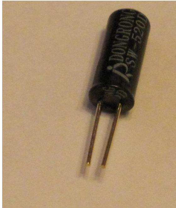
**Fig.3.39.** Sensor de vibración SW-520D
