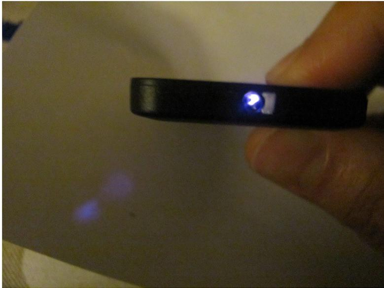
**Fig.3.32.** Destello luminoso detectado por una cámara digital al apretar un botón del mando a distancia
