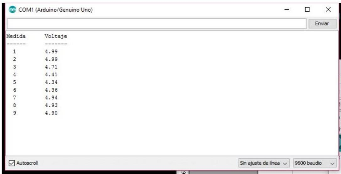
Fig.3.28. Disminución del voltaje entre las medidas 3 y 6 debido a la presencia de una llama
